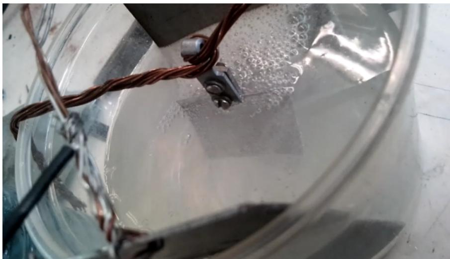
Рис. 4. Электролиз водного раствора NaCl (15 %).
